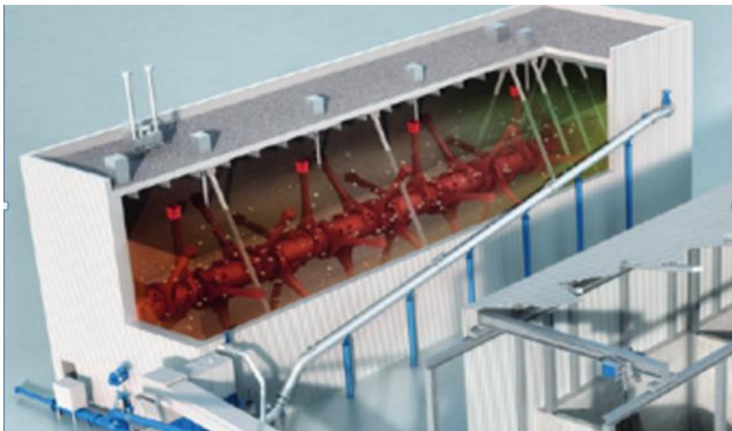
Kuva 12. Periaatekuva kuivamädätysreaktorista, Thöni/Martin
